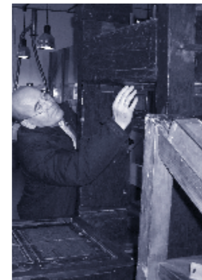
Werkstatt Museum der Arbeit, Hamburg (links) Spindelpresse für den Buchdruck, um 1780. Sämtliche Drucke seit Beginn des Buchdruckes um 1440 bis 1800 stellten die Drucker auf solchen hölzernen Handpressen her. (rechts)
