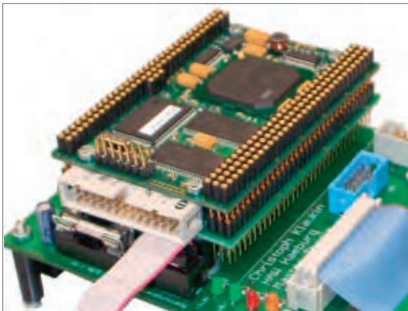
Bild 8: Platinenstapel aus D.Module.C6713, D.Module.PCM3003 und Kommunikations- platine
