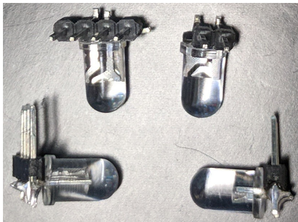
Abbildung 13: LEDs mit Stiftleisten
