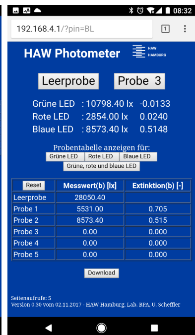
Abbildung 35: Durch Drücken von einem der „... LED „Buttons wird nur der jeweilige Ausschnitt der Tabelle angezeigt
