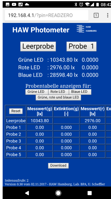
Abbildung 31: Drücken von „Leerprobe“ führt eine Messung aus und trägt die Daten in die Tabelle ein
