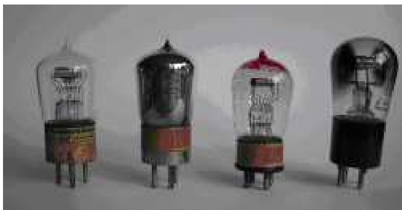
Bild 5 : Direkt geheizte Röhren mit Glühfäden. Von links: reines Wolfram, thoriertes Wolfram, Oxidbelag, Bariumbelag
