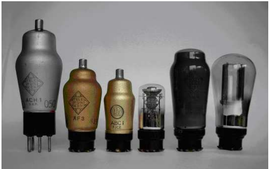
Bild 6: Röhrensatz für einen Superheterodynempfänger 1935: Misch-, Zwischenfrequenzverstärker-, Demodulator- und Niederfrequenzverstärkeröhre, magisches Auge, Lautsprecher- und Netzgleichrichterröhre
