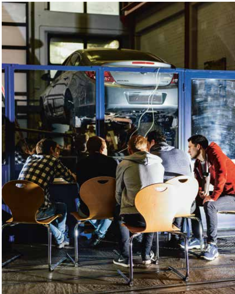
Das Fahrzeug »fährt« auf einer hydraulisch simulierten Rüttelstrecke, Studenten steuern die Messungen und werten sie aus.
