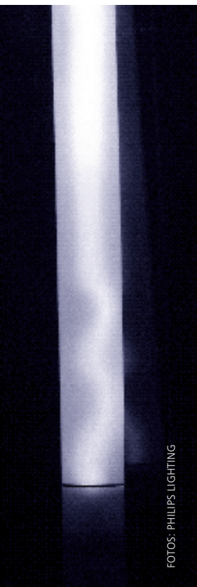
Durch eine akustische Resonanz gestörter Lichtbogen.
