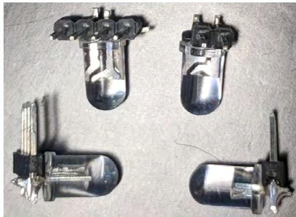
Abbildung 13: LEDs mit Stiftleisten
