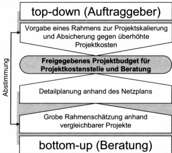
Abbildung 1: Vorgehen zur Erstellung eines Projektbudgetplans im zeitlichen Ablauf anhand ausgewählter Aufgabenpakete Wegmann, Winklbauer, 2006, S. 127
