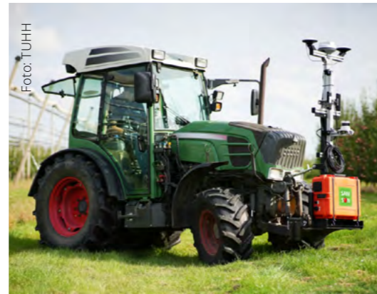
Traktor mit hochauflösenden stereoskopischen Kameras
