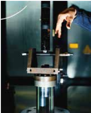
Hier sieht man, wie ein einzelner Stoßdämpfer in den Prüfstand eingespannt wird.
