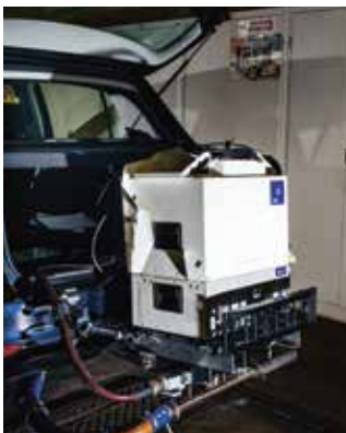
Abgasmessung. Das Gerät erinnert optisch an einen Kühlschrank, ist aber teurer als das Fahrzeug, das getestet wird.
