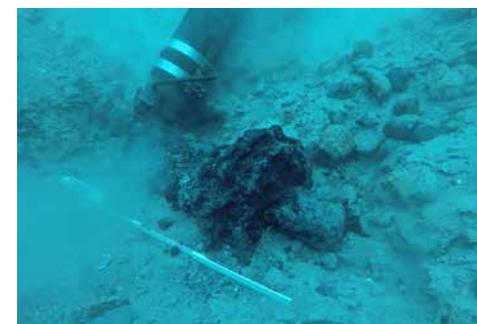
Korrodierter Aufbewahrungsbehälter am Boden der Ostsee
