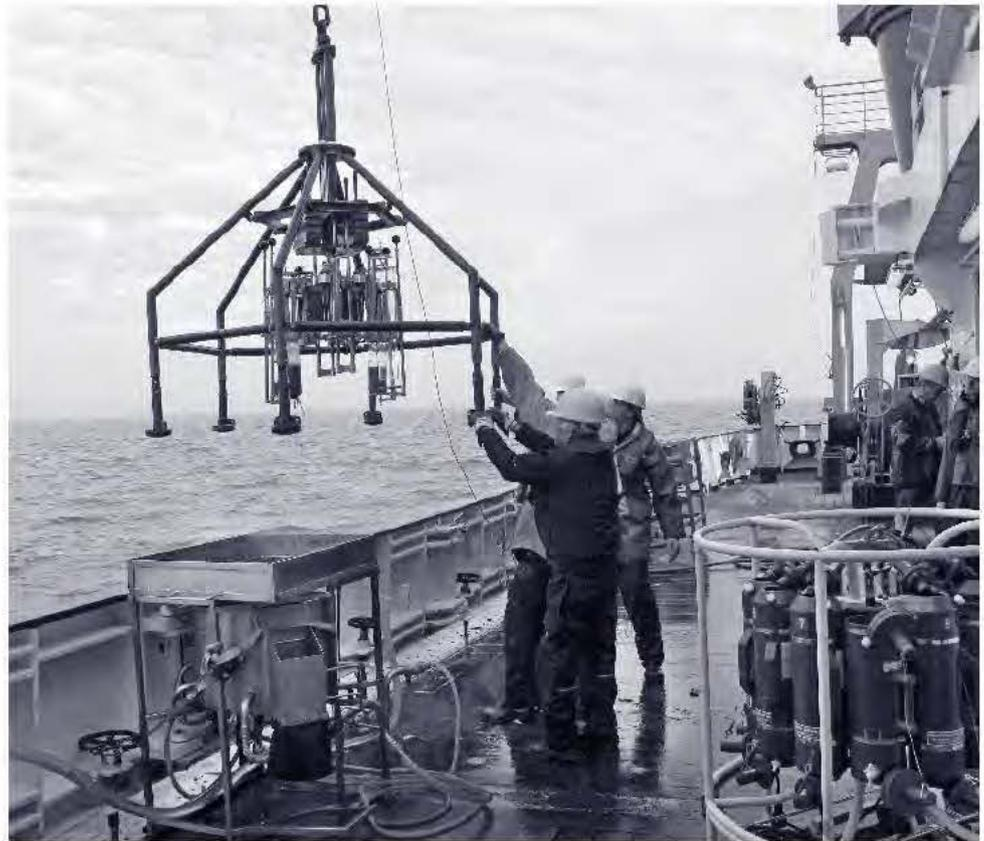
Probenahme von Sedimentkernen mit einem Multicorer (Stechrohr)
