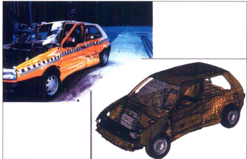
Bild: Durch Crash - Berechnung und Simulation können Prototypen eingespart werden. Dadurch reduzieren sich die Entwicklungszeit und die Kosten
