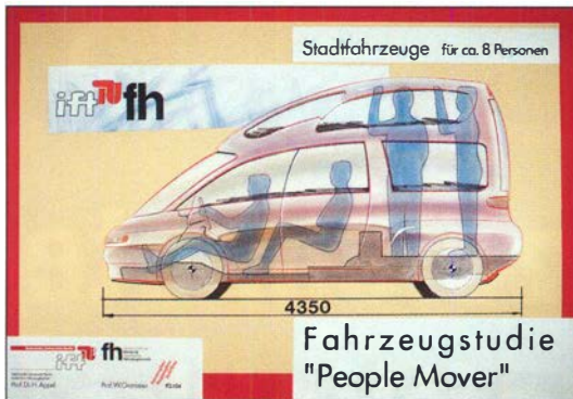
Bild 41 (links): Projekt "People Mover", in Verbindung mit der TU Berlin erarbeitetes Konzept für ein Großraumfahrzeug mit variabel nutzbarem Innenraum.
