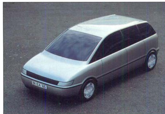
Bild 14 (rechts): Präsentationsmodell CNC-gefräst, M 1:5
