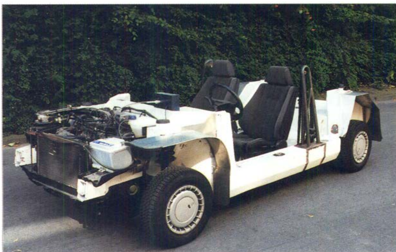
Bild 1: Universal-Chassis mit hoher Torsions- und Biegesteifigkeit in Blech Kanteilbauweise.
