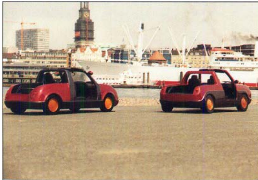
Bild 37 (links): Karosseriekonzepte auf der Basis des "Hamburger Chassis", einem selbsttragenden Fahrzeugchassis mit VW-Golf ähnlichen Abmessungen und erteilter TÜV Zulassung als Basis für verschiedene Aufbauten. Entwürfe: A. Wollesen und D. Junge 1995
