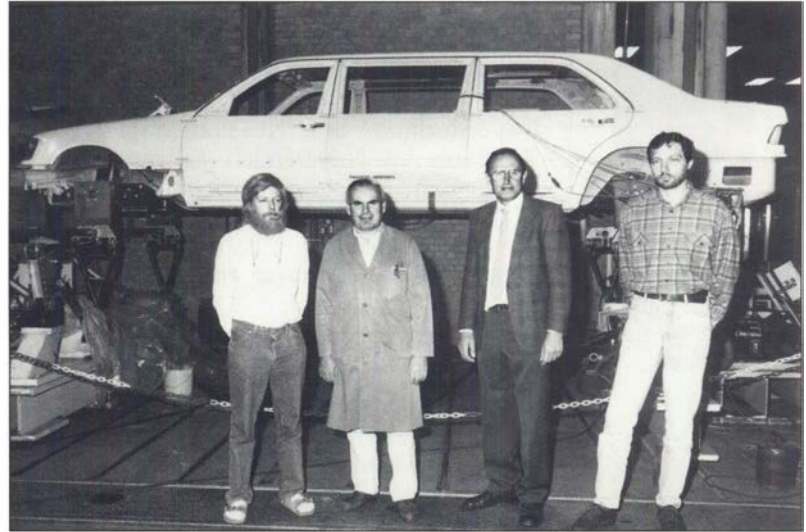
Bild 7: Verlängerte W140 Karosserie auf der Hydropulsanlage
