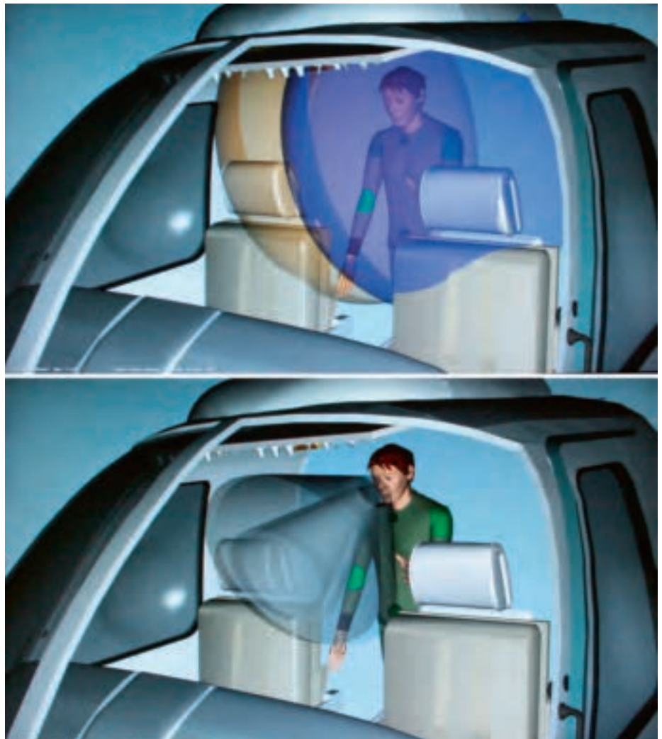
Abbildung 7: Ergonomiestudie in der CAVE, Arbeitsbereich im oberen und Sichtbereich im unteren Teil des Bildes
