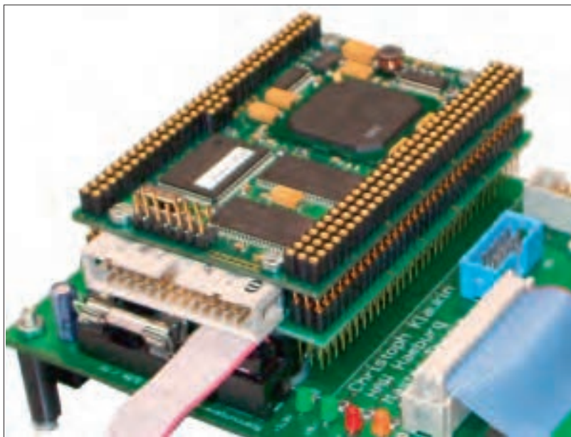
Bild 8: Platinenstapel aus D.Module.C6713, D.Module.PCM3003 und Kommunikations- platine
