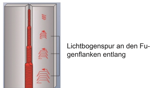
Abbildung 41: Drahtelektrodenführung und Lagenaufbau beim Schweißen von senkrechten Stumpfnähten
