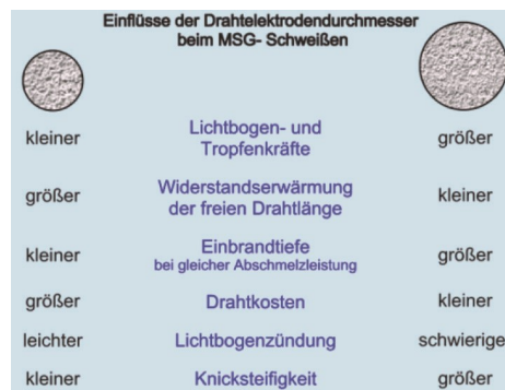
Abbildung 46: Einflüsse der Drahtelektrodenndurchmesser beim MSG-Schweißen
