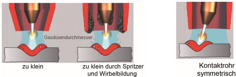
Abbildung 68: Poren durch Fehler am Brenner
