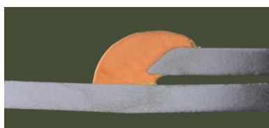
Abbildung 78: Einfluss der Lichtbogenart auf das Profil der Lotraupe / 2 /
