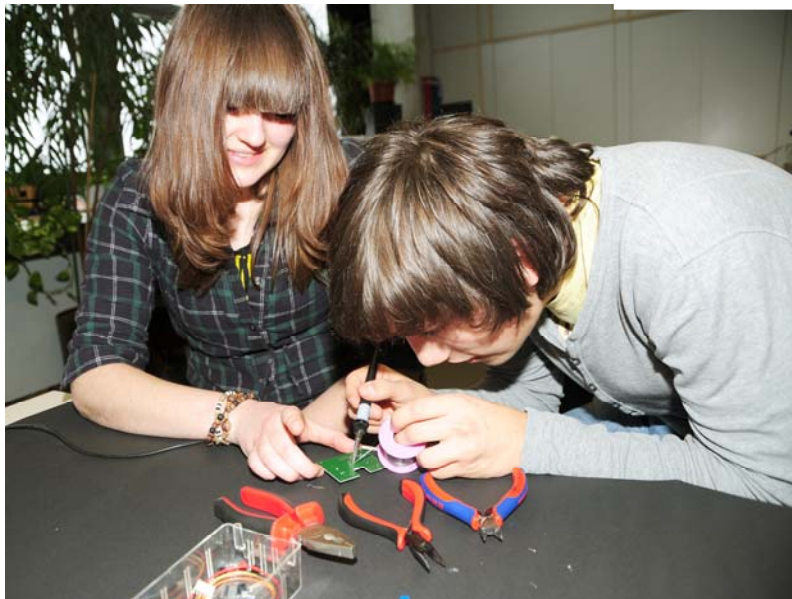
Abbildung 7: Lötten des Photosensors im Labor für Umwelttechnik und Elektronik
