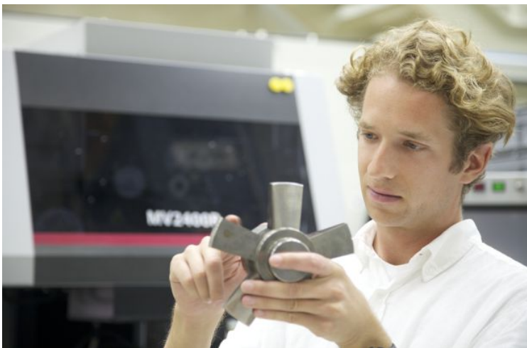
Abbildung 2: Rohling für einen Kühlluftimpeller (Cooling Fan Rotor) vor der mechanischen Bearbeitung
