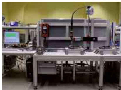
Prüfstand mit EC-Schraubspindel zur Aufnahme von Drehmomentsignaturen
