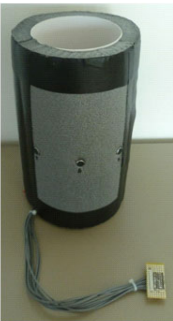
Bild 2: Zylindrisches Mikrofonarray aus 8 Mikrofonkapseln, die in Schaumstoff sitzen
