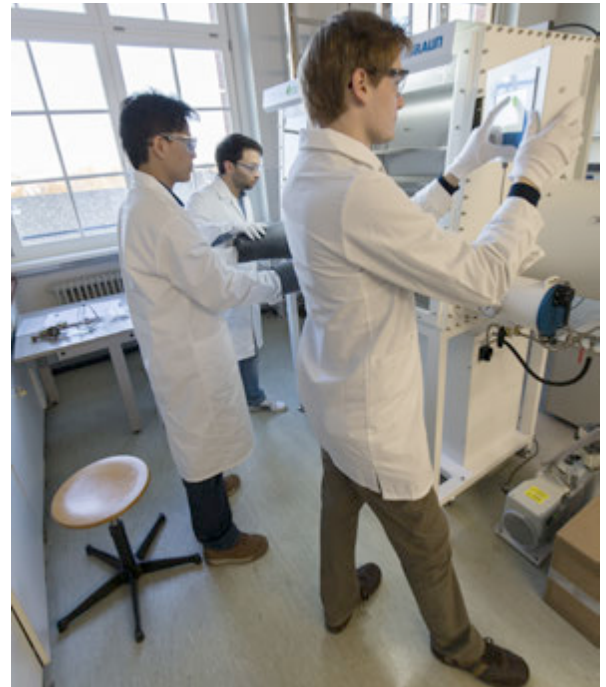
Die Schutzgasbox wird über ein Touch-Panel bedient, über eine Vakuumschleuse können Material und Geräte in die Box eingebracht werden.
