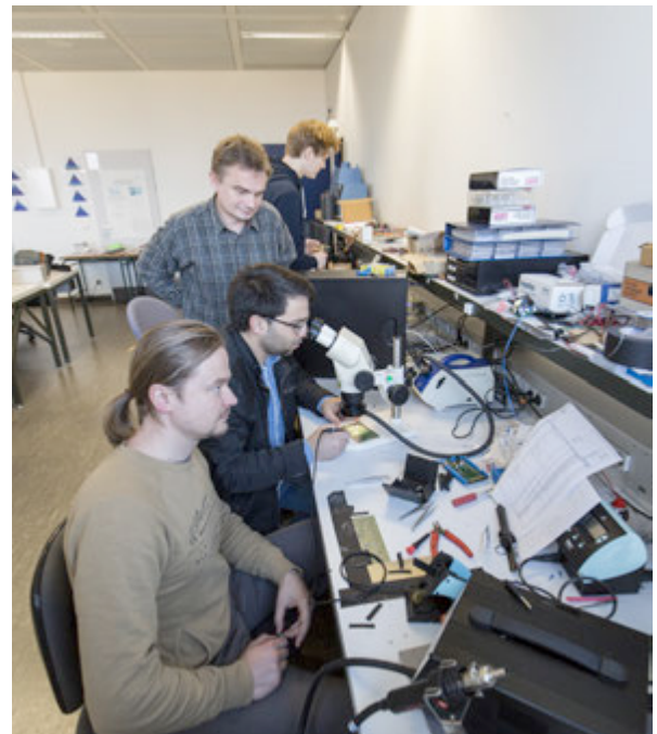
Im Labor werden Schaltungen und Platinen in SMD-Technik entwickelt und bestückt. So können für die speziell auf die Forschungsprojekte zugeschnittene Geräte entstehen.
