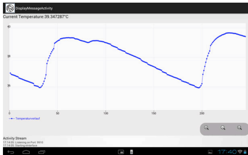
Abbildung 4: Temperaturverlauf des Speichers im Realbetrieb, dargestellt in der Android-App
