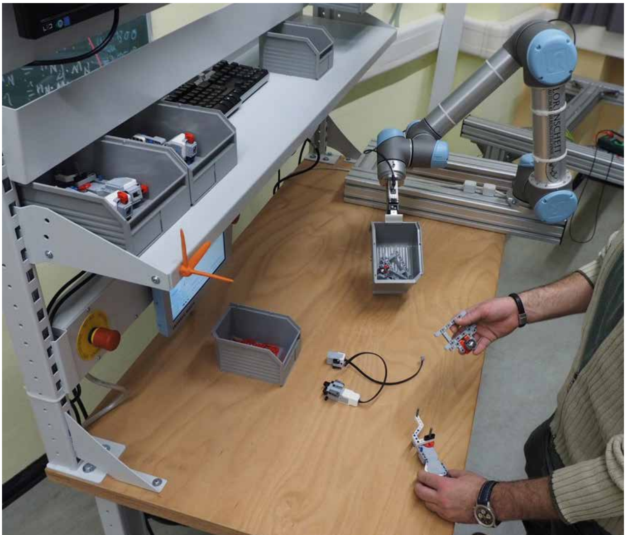
„Dritte Hand gefällig?“ - Interaktives Montageszenario mit UR5-Roboter
